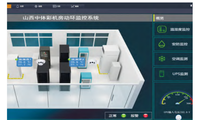
▲ 机房动环监控系统
